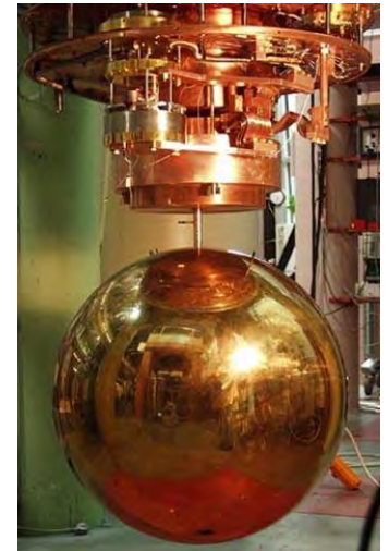
球形アンテナ (TIGA計画) 全指向性 大質量
