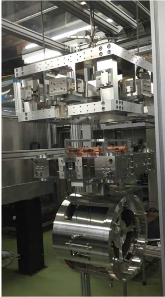
低温懸架装置試作 (KEK, 2016年)
