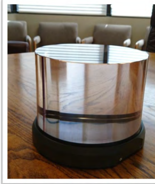
サファイア鏡基材 (直径22cm, 厚さ15cm, 重さ23kg)
