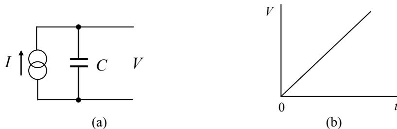
図 1-4 定電流によるコンデンサーの充電
