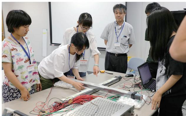
「宇宙線速度測定班」は、机の上下に設置した二本の測定装置「シンチレータ」で、宇宙から降ってくる宇宙線を捉え、測定データから速度を計算する取り組みに挑戦。予想外の結果をどう解釈すべきか考察を深めるといふ研究の醍醐味を体験しました。
