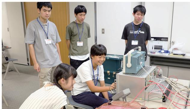
「ワイヤーチェンバー班」は、ガスを満たした容器内にさまざまな太さのワイヤーを張り、荷電粒子の飛跡を捉えるワイヤーチェンバーを自作し、X 線源やベータ線源などを使ってその性質を調べる試みに挑戦しました。
