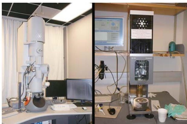
Fig.7 UCSF の電子顕微鏡 (左) とクライオ実験装置 (右)。
